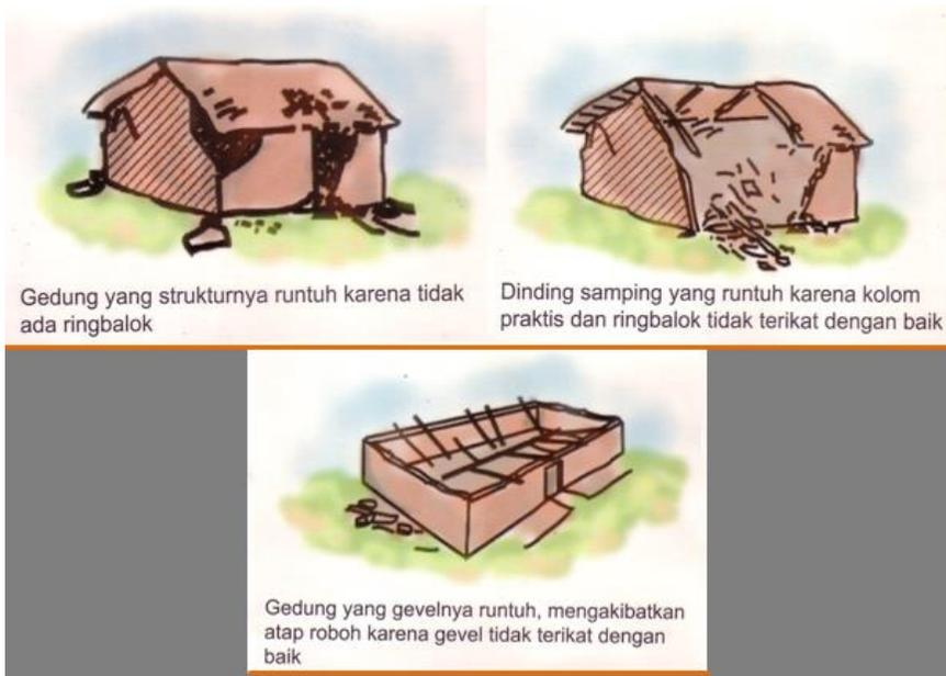
Gambar 64: Konstruksi terhadap Gempa
